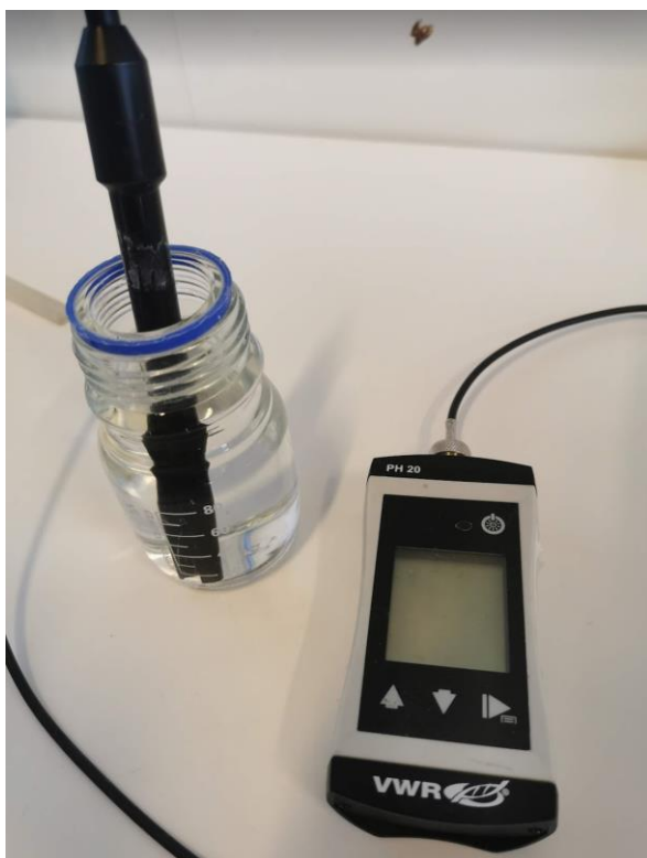
Figur 25: Bilde av pH meter av typen "VWR PH20", tatt av Andreas Stenseth 28 april.
