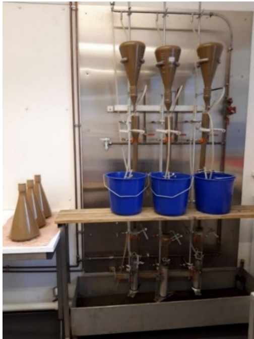
Figur 15 Seinhorstelutriator ble brukt til ekstraksjon av frittlevende nematoder fra jordprøver tatt hos Fonn-Holand gård.
