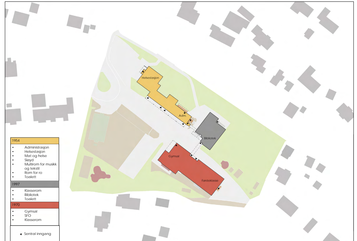
Figur 19: Innendørsfunksjoner, med fast plassering av helsestasjon, administrasjon, bibliotek, gymsal og første klasse. Inkludert er sentrale innganger for elever og ansatte
