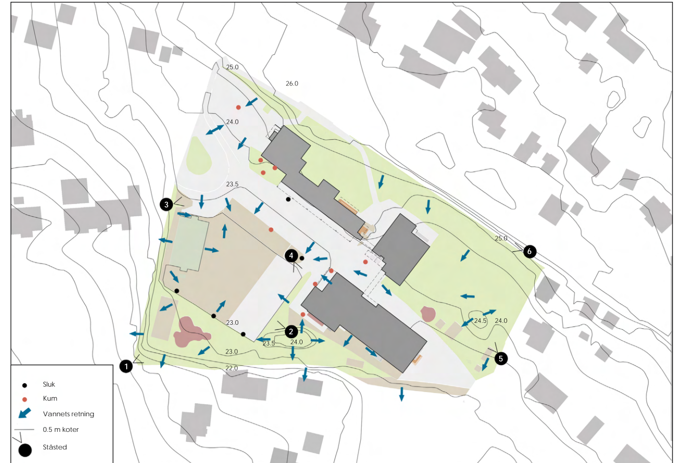
Figur 44: Terrengforhold, vannets retning, kummer og sluk
