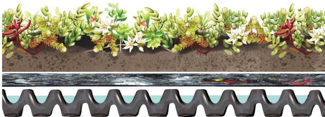
Figur 3: Eksempel på oppbyggingen av et ekstensivt grønt tak fra Bergknapp AS.
