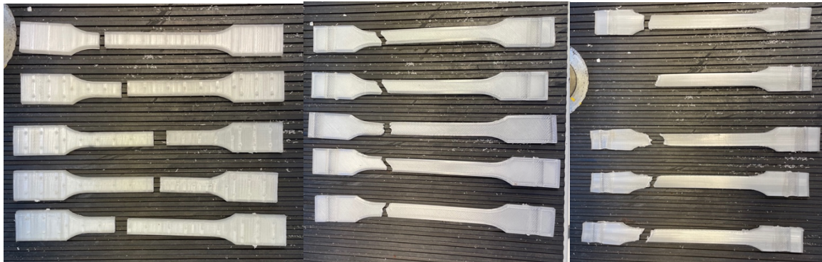
Figur 34: Til venstre: prøvestaver som er produsert langs z-akse, i midten: Prøvestaver som er produsert liggende på byggeplattformen og til høyre er stavene som er produsert stående vertikalt på XY-planet.
