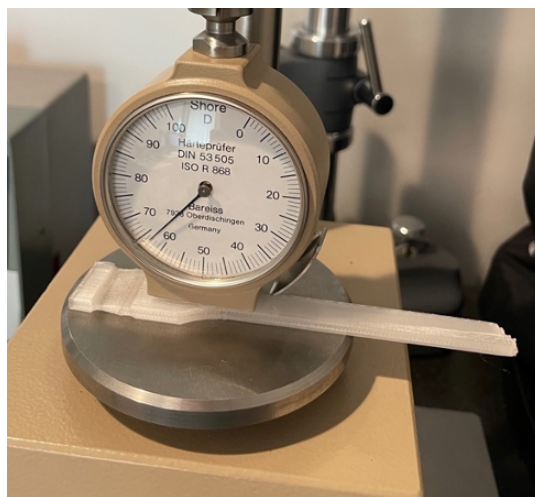
Figur 38: Utføring av Shore D test *)
