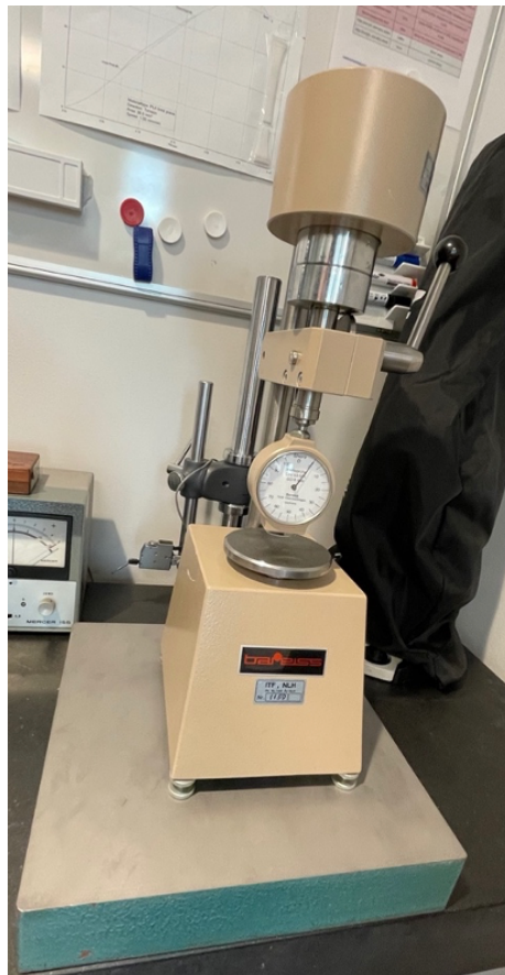
Figur 36: Maskin satt opp til Shore D test
