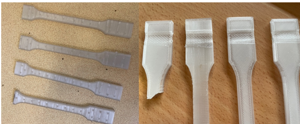
Figur 35: Observasjon av andre typer brudd i prøvestavene som har blitt produsert langs Z-aksen, og deformasjon i prøvestavene som har blitt produsert med annen orientering
