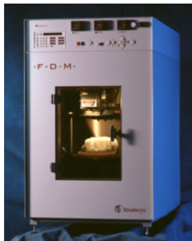
Figur 1: Den første AM-maskinen som kom til NMBU. Dette var en Stratasys FDM Hentet fra: [101]
