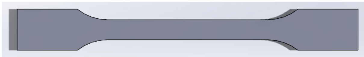
Figur 51: Prøvestav produsert etter ISO 527-2:2012
