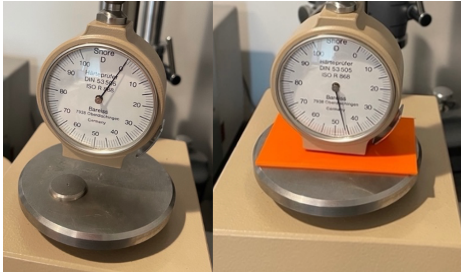
Figur 37: Installasjon (Venstre) og kalibrering av durometeret (Høyre)
