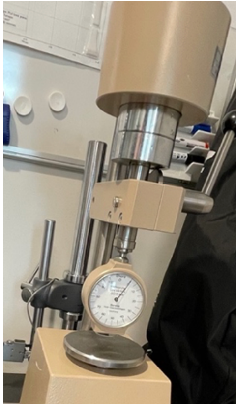
Figur 30: Maskinoppsett til en Shore D test plassert på et planbord
