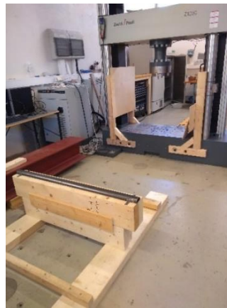
Figur 28 - Testoppsett for nedbøyning
