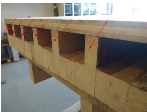
Figur 23 - Påskruing av topplate
