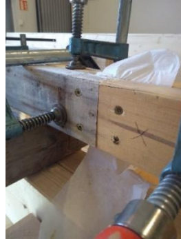
Figur 19 - Sammenliming av fingerskjøt
