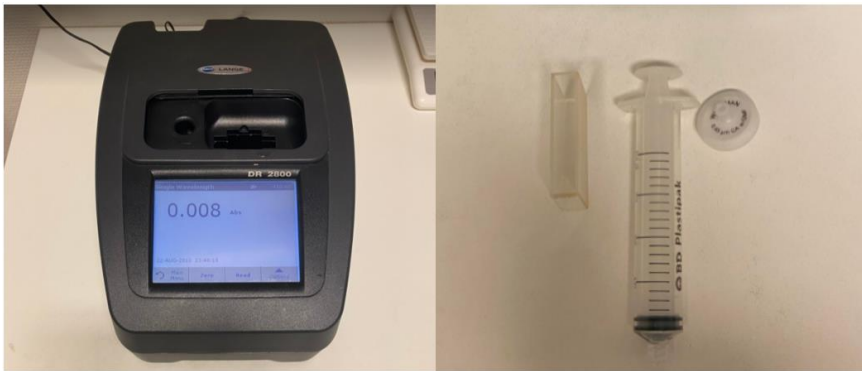
Figur A-4: Spektrofotometer for måling av farge med kyvette, og sprøyte og cellulosenitratfilter som tilleggsutstyr for filtrering av vannprøven.
