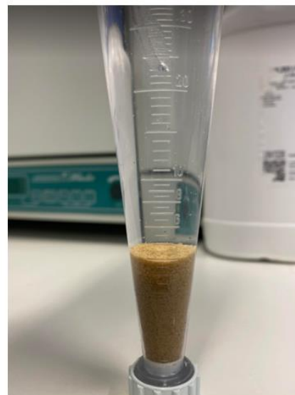
b) A100 som flokkulant ved pH 5,75 og dosering 0,75 mg/l.
