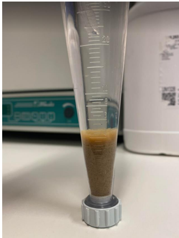
Figur 4-13: Lagdelt sedimentert slam ved pH 6,45 og polymerdosering 0,75 mg/l med KitoFlokk som flokkulant.
