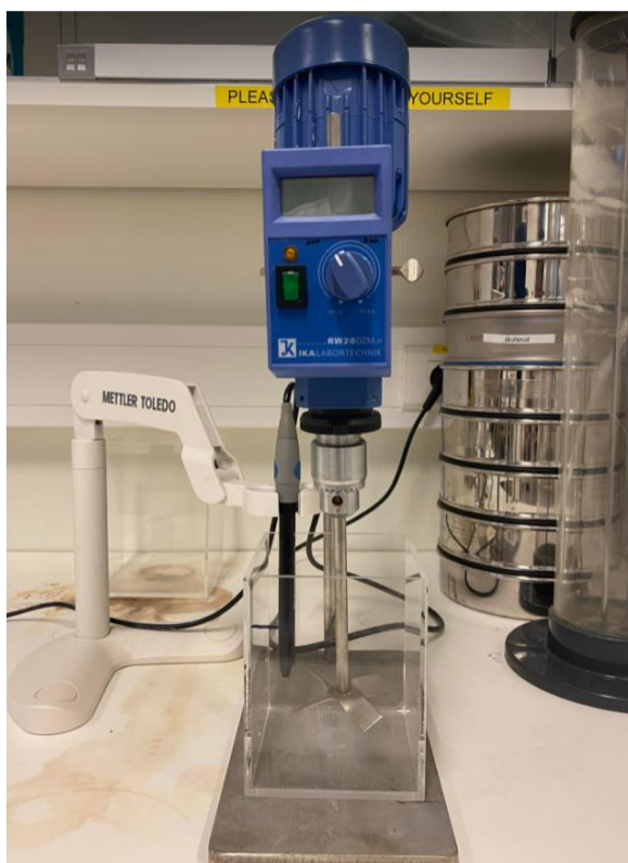
Figur 3-1: Actiflo jar-test oppsett benyttet i forsøket med omrører fra IKA RW20 og pH-meter og elektrode fra Mettler Toledo.
