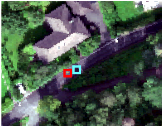
Figur 2.6: Spektralsignaturen for asfaltert vei med og uten skygge. Bildet viser en rød og lyseblå firkant som representerer et asfaltert område med og uten skygge. Grafen viser spektralsignaturen til begge områdene med de samme fargene.
