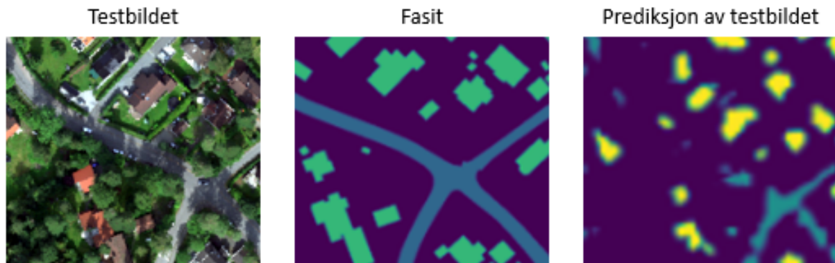
Figur 5.1: Predikering av et området bestående av blant annet asfaltert vei med og uten skygge. Illustrasjonen viser tre bilder; testbildet, fasiten og prediksjonen av testbildet.
