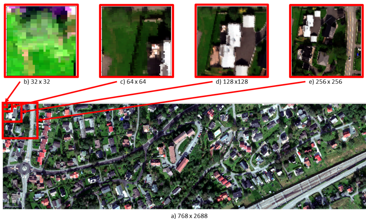
Figur 3.8: Ulike bildekvadratst rrelser vises p  fig b(32x32),c(64x64),d(128x128),e(256x256). De fire st rrelsene er representert sammen med omr de 04 i fig a.
