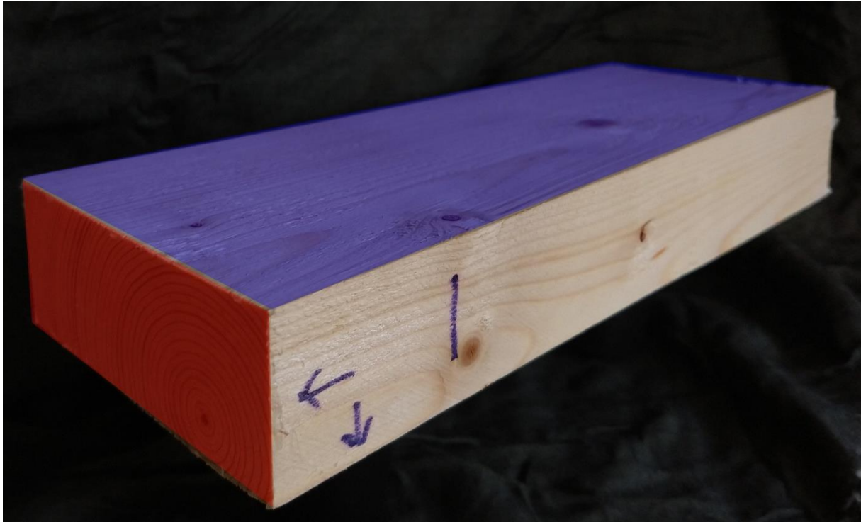
Figur 16. Forklaring til bilder av tverrsnitt. Flaten markert med rødt er tverrsnittet vist i Figur 15. Flaten markert med blått er flaten som er skannet. I prediksjonsbildene vist i oppgaven vil tverrsnittflaten være på venstre side av bildet.
