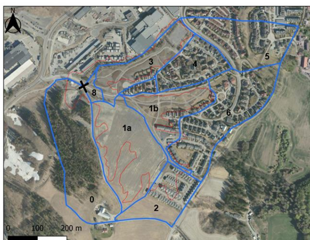
Figur 5: Nedbørfelt til det nedlagte avfallsdeponiet. Inndeling etter overvannshåndtering. Utarbeidet av (Norconsult AS, 2017).
