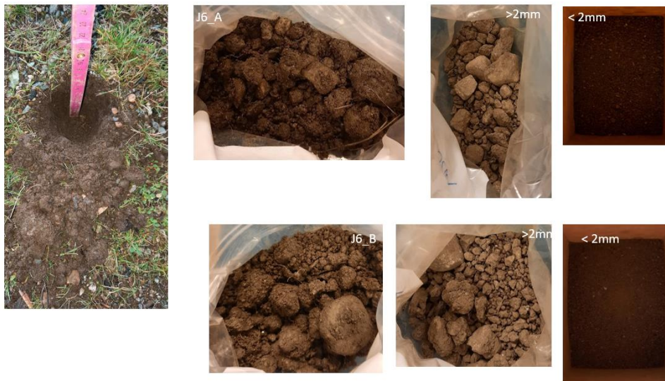
Figur 5.7: fra venstre mot høyere bilder fra jordprøvetaking i felt, jordprøve før tørking og jordprøve etter tørking og sikting mellom fraksjonene >2mm og <2mm for jordprøve prøvepunkt 6.
