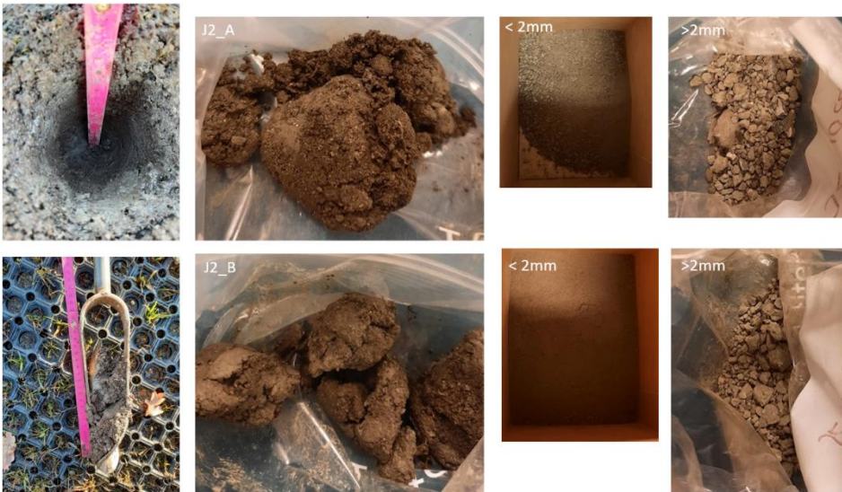
Figur 5.3: fra venstre mot høyere bilder fra jordprøvetaking i felt, jordprøve før tørking og jordprøve etter tørking og sikting mellom fraksjonene >2\text{mm} og <2\text{mm} for jordprøve prøvepunkt J2.
