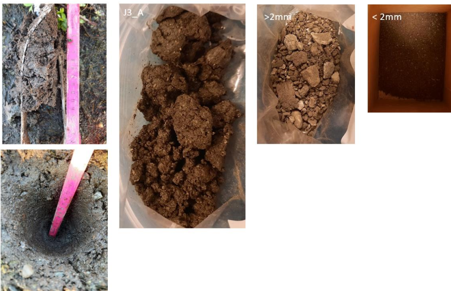
Figur 5.4: fra venstre mot høyere bilder fra jordprøvetaking i felt, jordprøve før tørking og jordprøve etter tørking og sikting mellom fraksjonene >2\text{mm} og <2\text{mm} for jordprøve prøvepunkt J3.
