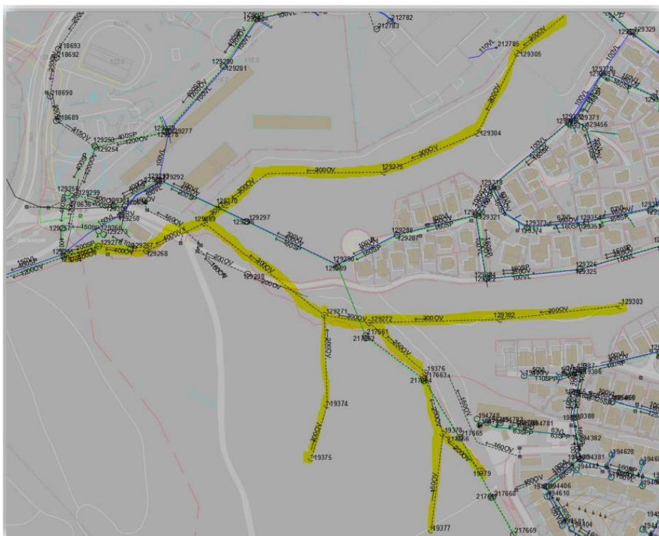
Figur 3: Kart utsnitt over tidligere ravinebekker lagt om i omstøpte betongrør. Gullinje marker bekkelukkingene. Hentet fra (Norconsult AS, 2017).
