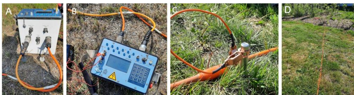
Figur 13: Oppsett av ERT utstyr i felt. Flerlederkabler koblet til Syscal Pro (IRIS Instruments) (A). Display (B). Elektrode tilkoblet flerleder-kabel med krokodille klype (C). Eksempel på ERT linje lagt ut i felt (D).
