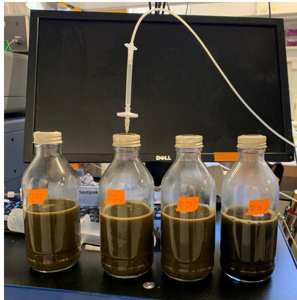
Figur 3.4: Flaskene brukt til BMP-testene. Her måles gasskonsentrasjoner gjennom en gasskromatograf. Prøvene inneholder slam fra Hurdalssjøen vannbehandlingsanlegg.
