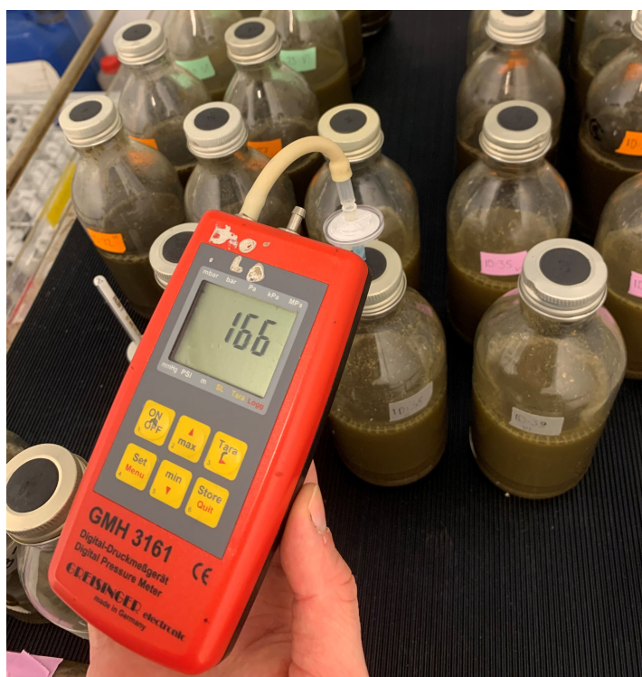
Figur 3.12: Oppsett for måling av trykk i reaktorflaskene.
