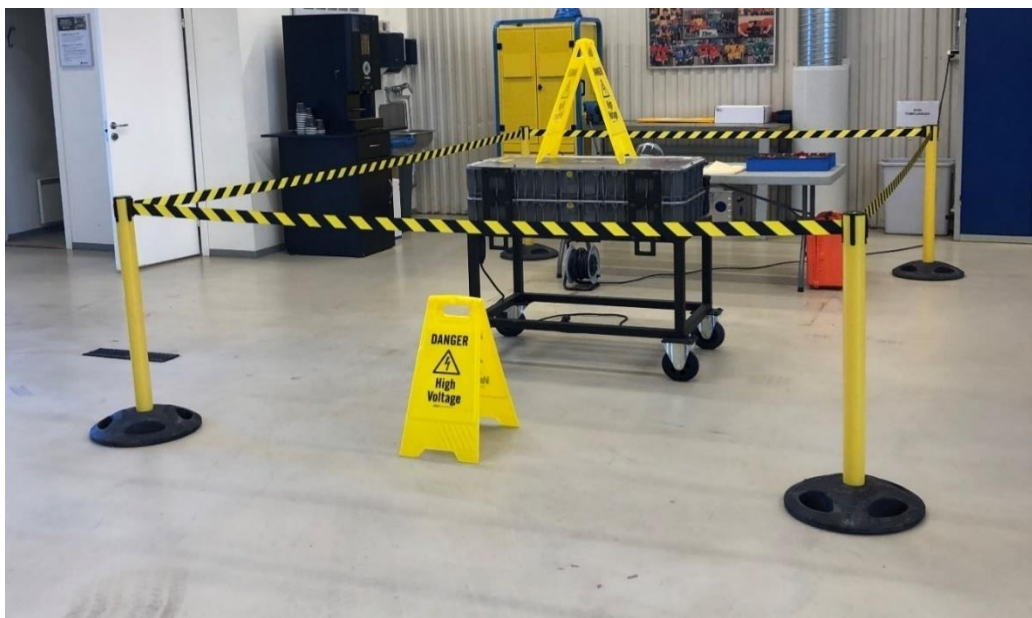
Figur 26 - Avgrenset område for arbeid på batteri fra elektrisk lastebil Kilde: Scania
