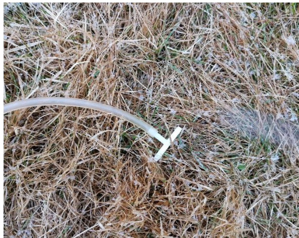
Figur 3.12 T-rør på slange som måler utvendig trykk
