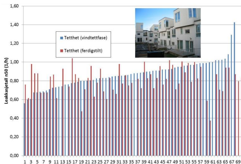
Figur 2.5 Tetthetsmålinger fra boligfeltet Jåtten øst i 2008 (Blom & Uvsløkk, 2012)
