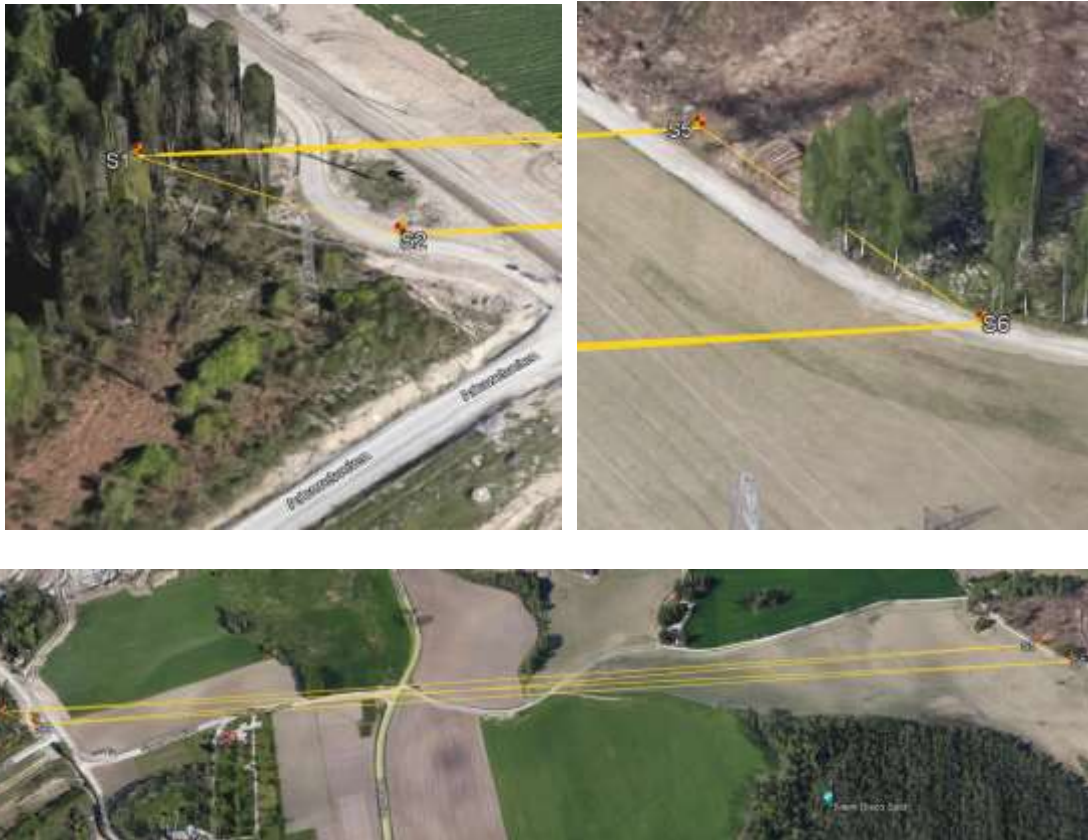
Figur 3.2 Oversikt over testfelt og de beregnede punktene med totalstasjon. Hele testfeltet er vist i figur 3.2 c, imens a og b viser plassering av punktene S1, S2, S5, og S6 forstørret.
