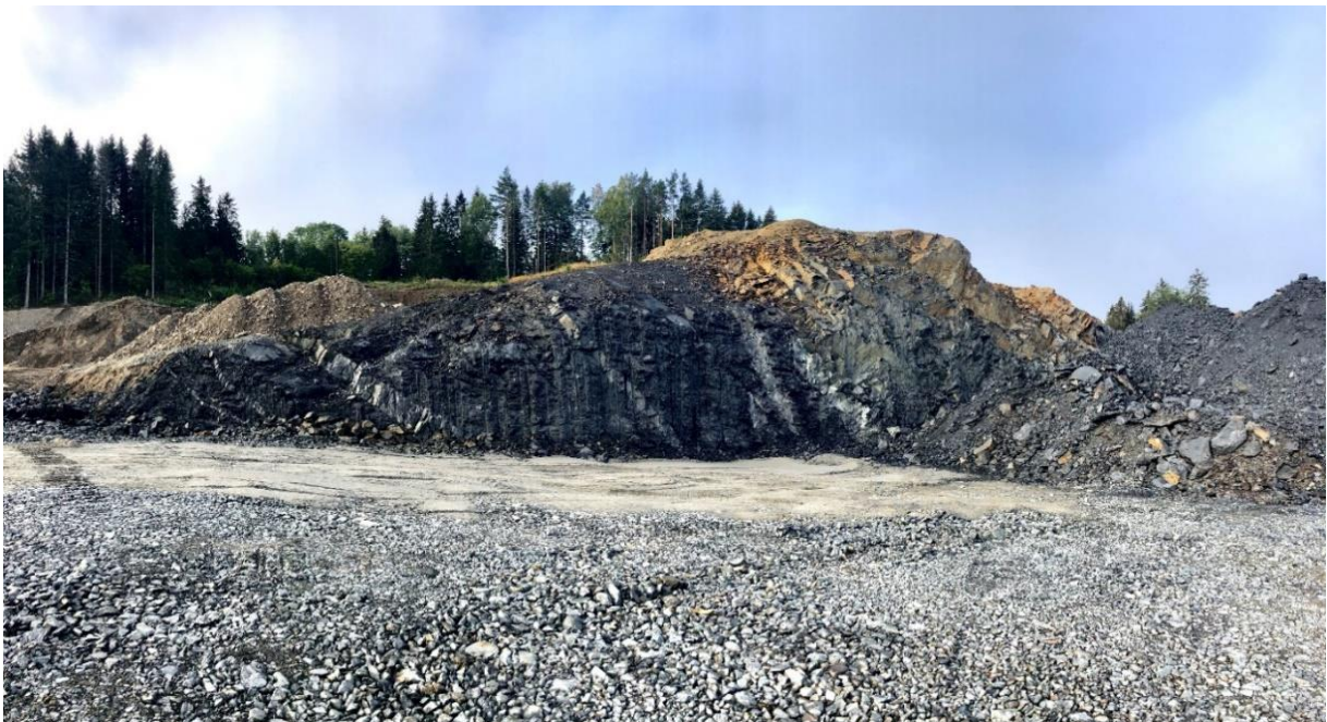
Figur 11: Veiskjæring i profil. Svartskiferen har svakt skrående, sedimentær laginndeling, mens mænaittgangen (lysgrå) til høyre i bildet er massiv (uten laginndeling). Svartskiferen er også gjennomvannet av flere små mænaittganger.
