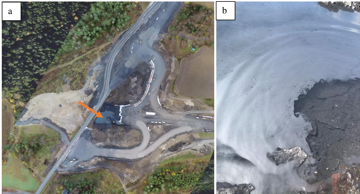
Figur 19: Dronefoto (a) fra anleggsområdet som viser vannansamling (markert med pil) i veiskjæringen (lok. U1), og nærbilde av manganutfelling i vanddammen (b).
