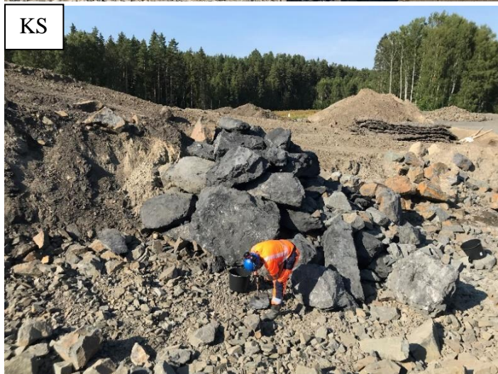
Figur 21: Alunskifer (SS) pigget fra traug (lok. U2), kalkrik svartskifer (KS) fra veiskjæring (lok. U1.2), B; forvitret svartskifer (FS) fra veiskjæring (U1.1).
