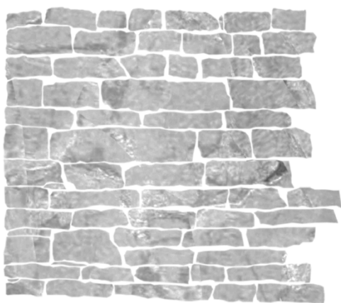
Figur 3: Romansk «mursteins»-mur. Illustrasjon av Martin Hopland. Fra STAD (Hopland, 2021, s. 14)
