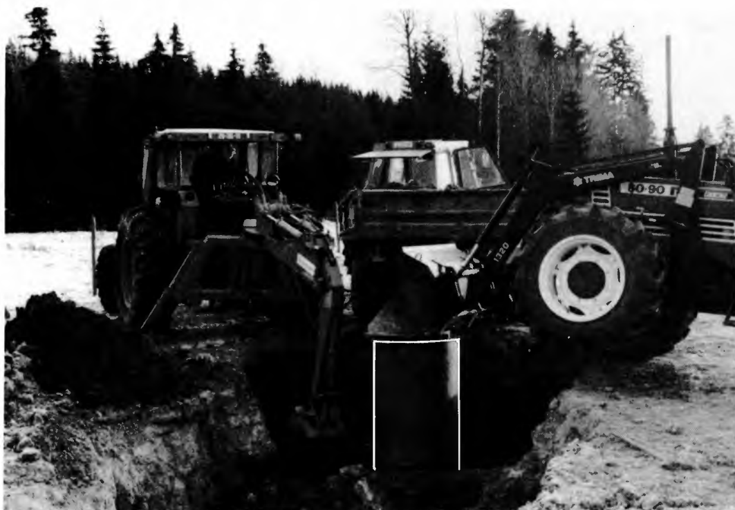
Figur 1. Utgraving av en uforstyrret jordsylinder, jordmonolitt Figure 1. Excavation of an undisturbed soil cylinder, soil monolith
