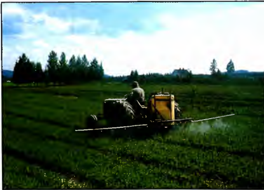
Omkring 1960 blei plasttank tatt i bruk i åkersprøyter. Det var en stor forbedring. Foto: Alf Nordby.
