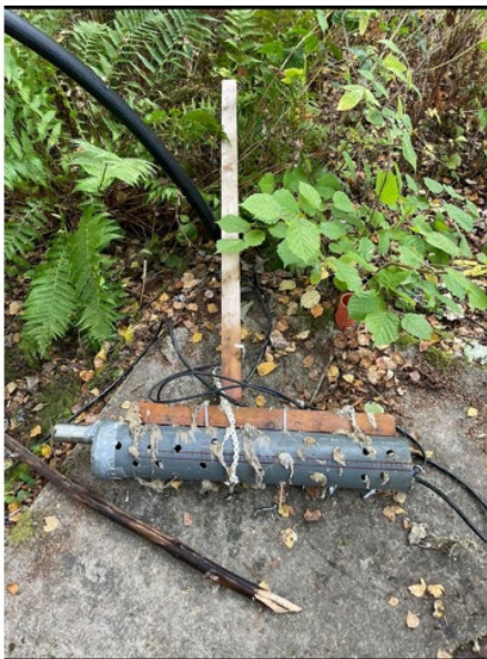
[18] Første innretning med PVC rør rundt sensorene, ble tettet igjen av papir. Noe papir var fjernet før bildet ble tatt
