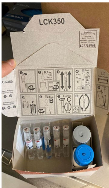
[12] Steg for måling av fosfat på HACH
