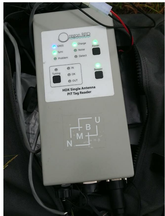
Bilde 10: PIT-leser fra Oregon RFID ble båret i en sekkeanordning på ryggen.
