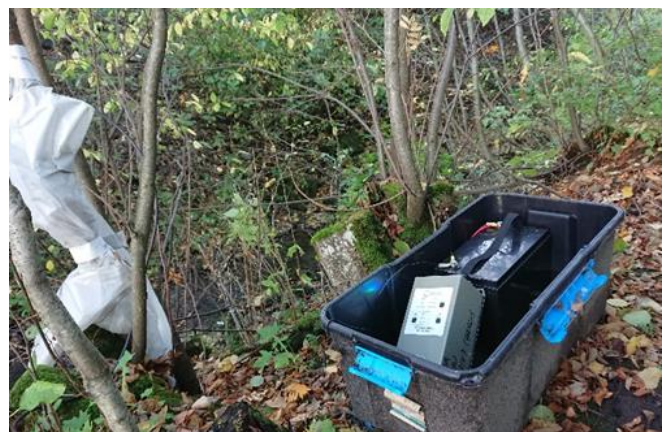
Bilde 8: PIT-leser i oppbevaringsboks og tilknyttet tuner (innpakket i plast til venstre). Her fra Korsådalbekken.
