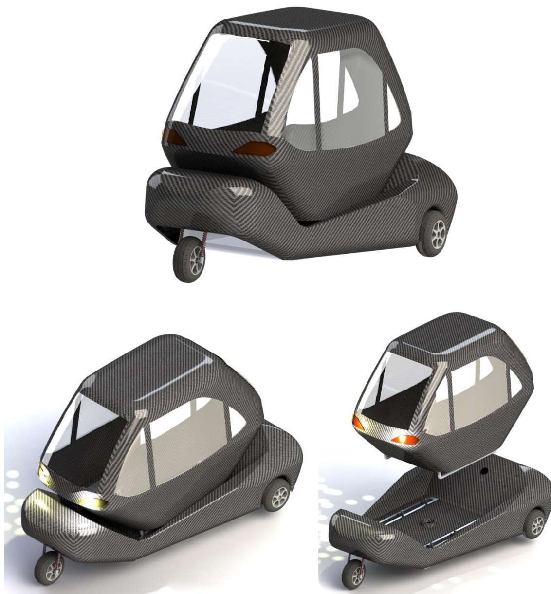
Figur 13.1: Figuren viser renderte bilder av modulkonseptet Dolphin. Det øverste bildet viser sammenkoplingen av understellmodulen og kupé, med karosseri og lykter. Nede til venstre vises bilen med lys i lyktene, og bildet nede til høyre viser hvordan modulene ser ut rett før sammenkopling, når kupéen senkes ned i understellet.
