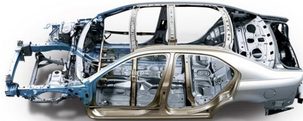
Figur 4.22: Eksempel på en monocoque ramme [52].
