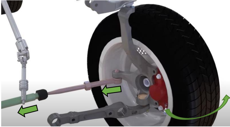
Figur 4.31: Illustrasjon med piler som viser at når racken dras mot venstre, dras nedre del av hjulet samme vei, som resulterer i at hjulet dreies utover. Det motsatte vil skje med hjulet som står på andre siden av racken [58].
