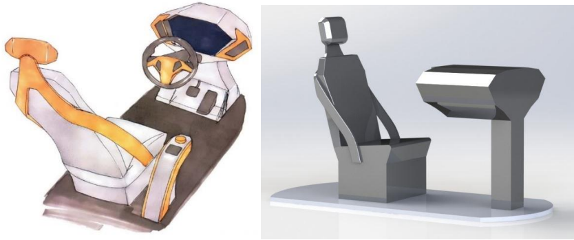
Figur 1.17: Illustrasjoner av Birkelunds konsept for interiøret i Dolphin Sky. Det er skissert og 3D-modellert løsninger for fører sete, ratt, instrument- og sidepanel [24].
