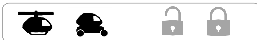
Figur 11.5: Figuren viser de fire sikkerhetssymbolene. Symbolene beskrives fra venstre. Det første symbolet representerer at Dolphin er i svevemodus. Det neste representerer bakkemodus. De to hengelåsene representerer at modulene ikke er låst sammen, og at de er låst sammen.
