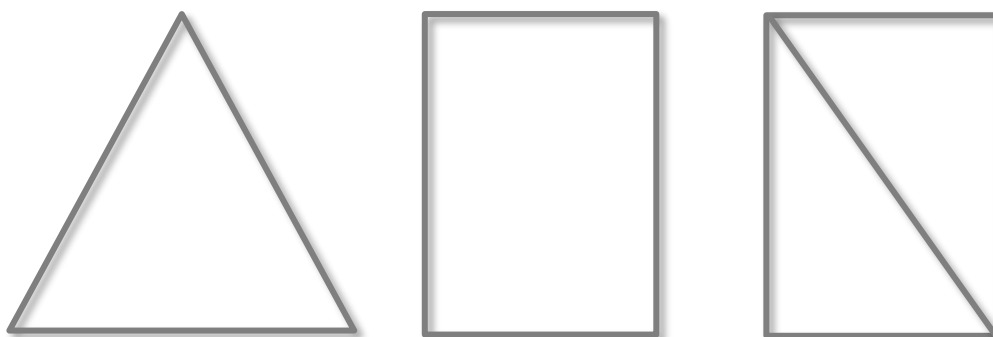
Figur 4.17: Figuren viser de grunnleggende geometriene som er å finne i rammedesign. Til venstre er en trekantramme, i midten en firkant og til høyre er en firkant med et stag i midten som stiver av strukturen.
