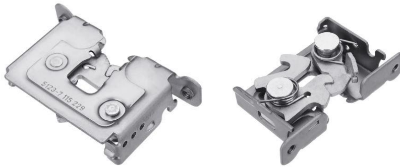
Figur 4.27: Eksempel på bonnet lås som benyttes i bildører BMW 1, 3 og 5 seriene [57]. Til venstre vises den ovenfra og til høyre vises den underfra med to bevegelige plater som er låst inn i hverandre, og to fjærer for å holde på plass platene.
