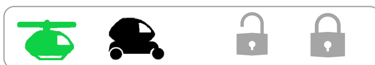
Figur 11.6: I svevemodus, lyser kun svevelampen, og den signaliserer at det er trygt å fly.
