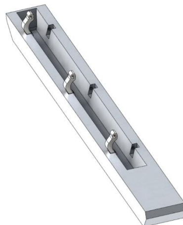
Figur 13.12: Låsearmen står i "åpen" posisjon og er klar for at kupéen skal lande ned i sporet.
