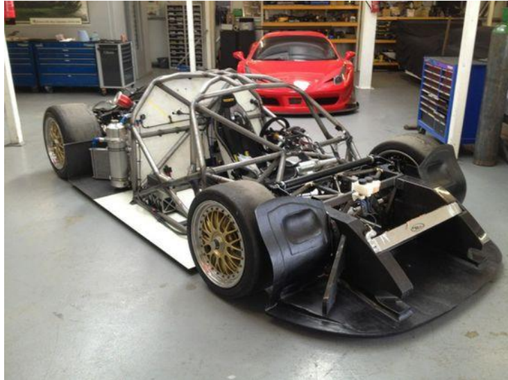
Figur 4.24: Et eksempel på rammekonstruksjoner i racerbiler. Her er flere trekkanter satt sammen for at danne et «bur» over førersetet og beskytte sjåføren [54].
