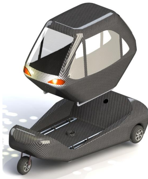
Figur 13.11: Figuren viser kupéens posisjon over understellmodulen, når den lander. Dronemodulen skal være plassert på taket til kupéen, kupéen klarer ikke å sveve av seg selv.
