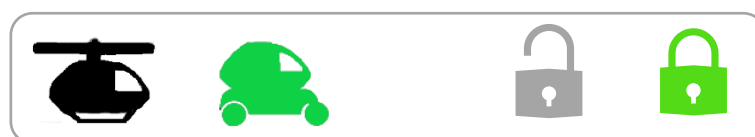
Figur 11.8: Når sammenkoplingen er komplett lyser både kjørelampen og låselampen grønt. De signaliserer at det er trygt å kjøre.
