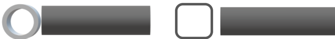
Figur 8.3: Illustrasjon av kontaktflatene ved sveising av rør. Til venstre er to sirkulære rør, til høyre er to firkantede.
