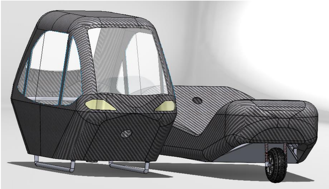
Figur 13.10: Kupémodulen er koplet fra understellmodulen, og bruker låsebena som landings plattform.
