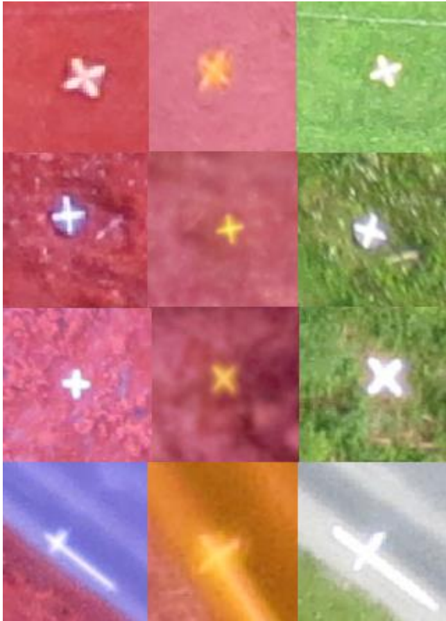
Figur 5: Bilder av passpunkter mellom kameraene RE, NIR og RGB. Bildene viser fire ulike passpunkter, først er et ferdiglagde passpunktene, deretter kumlokket, plastikkors og passpunkt langs etter veien.
