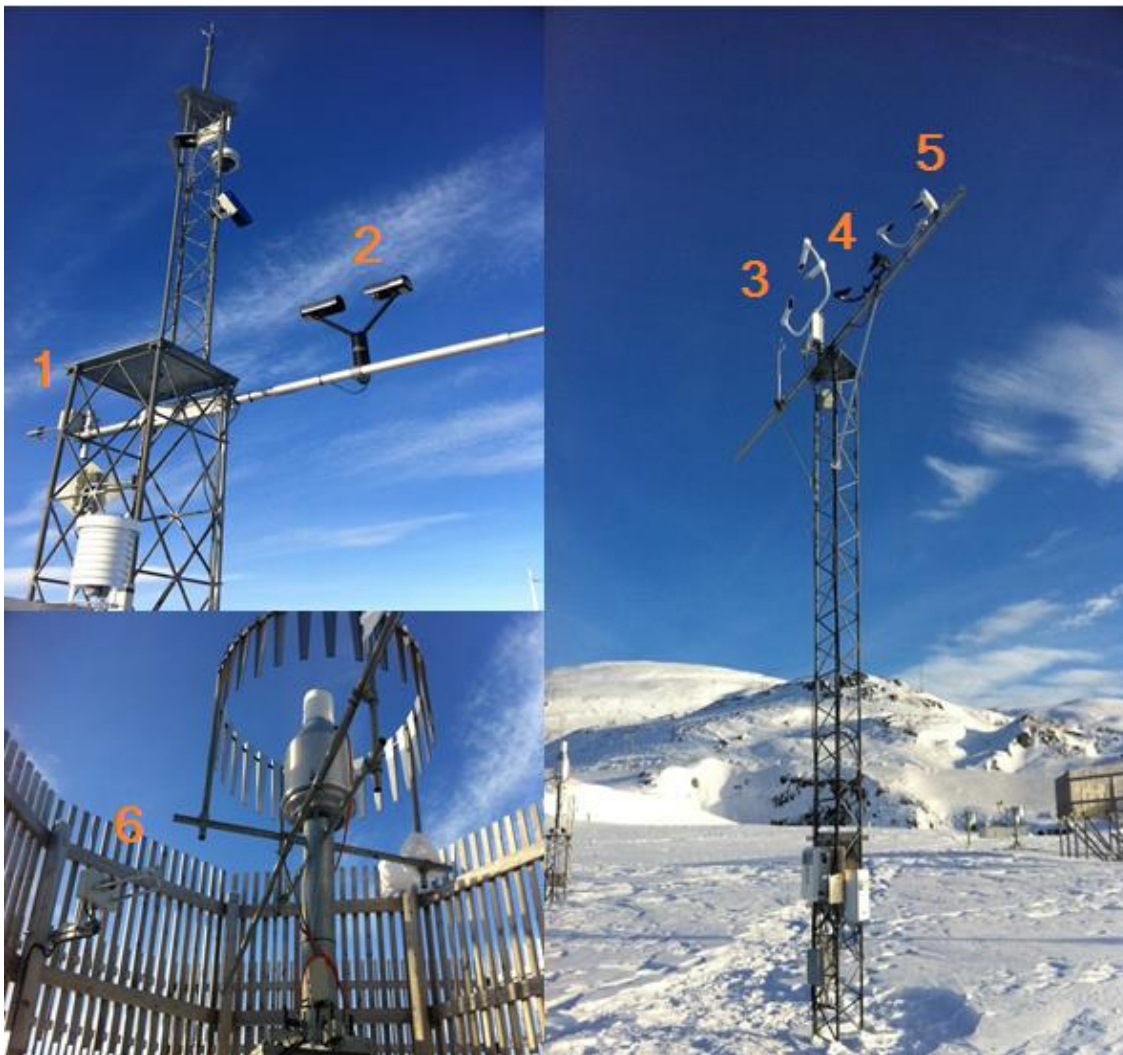
Figur 3.2.3.2: Bilder av de ulike Present Weather sensorene som befinner seg på testfeltet. Der 1 er Thies LPM, 2 er OTT Parsivel, 3 er Campbell PWS100, 4 er Vaisala PWD21, 5 er Vaisala PWD22, 6 er Thies LPM på innsiden av vindskjold.
