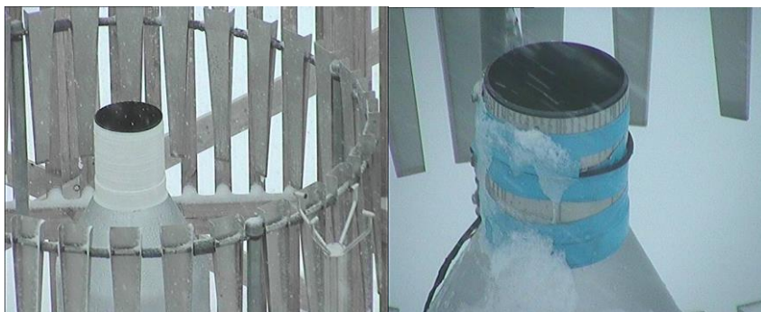
Figur 4.1.2: To bilder for bekreftelse av snø på testfelt. Venstre bilde viser Geonor DFIR den 3/22/14 kl. 15.16. Høyre bilde viser Geonor X1 den 12/20/13 kl. 12.08.
