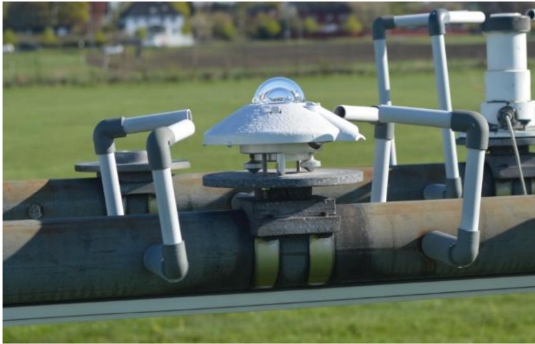
Figur 20: Pyranometer. Sensoren som registrerer strålingen er plassert i beskyttet atmosfære under glasskuppene.
