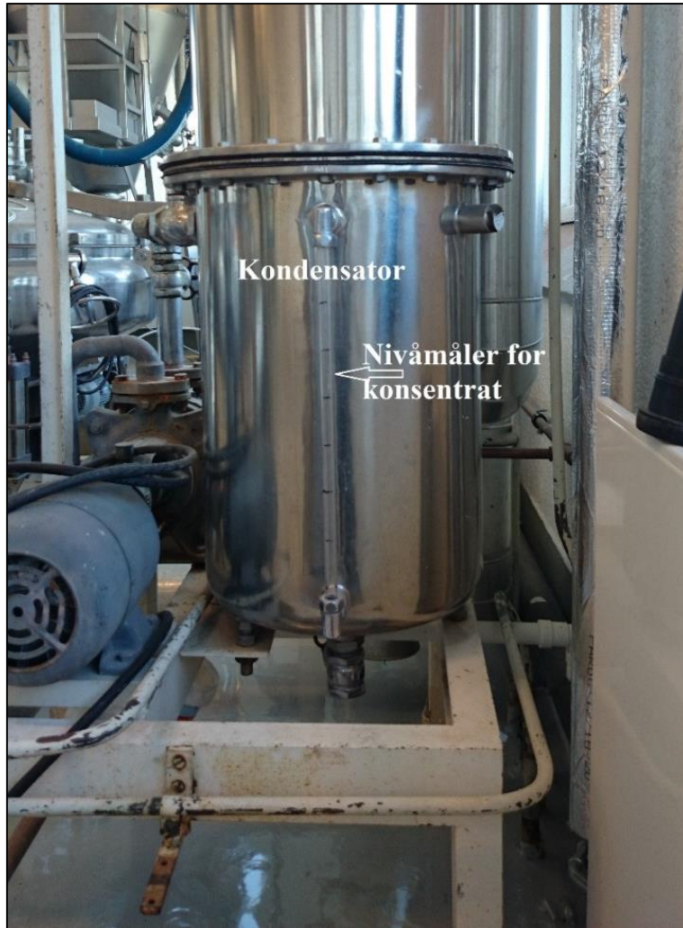
Figur 15. Bilde av tanken som samlet opp kondensat fra gryten. Søylen for avlesning hadde svarte punkter som viste antall liter kondensat. Ved den første svarte streken ville 10 liter være kondensert, ved de påfølgende strekene ville det være 5 liter kondensat for hvert punkt. Søylen hadde en maksimalgrense på 40 liter kondensat (Foto: Motrøen 2015).
