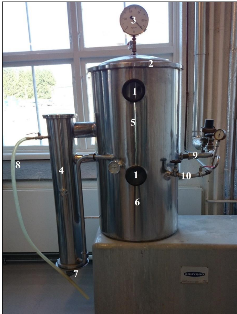
Figur 13. Bilde av Anhydro laboratory vacuum evaporator som ble benyttet i inndamping av første batch. Tegnforklaringer: 1. Seglass til separator (øverst) og kondensator (nederst), 2. Hovedlokk, 3. Manometer for vakuum og luftekran, 4. Varmevexsler, 5. Separator, 6. Kondensator, 7. Tappekran for konsentrat, 8. Slange og ventil for innsug av produkt, 9. Damptilførsel til varmevexsler, 10. Tilførsel av vann i kondensator. (Foto: Motrøen 2015)
