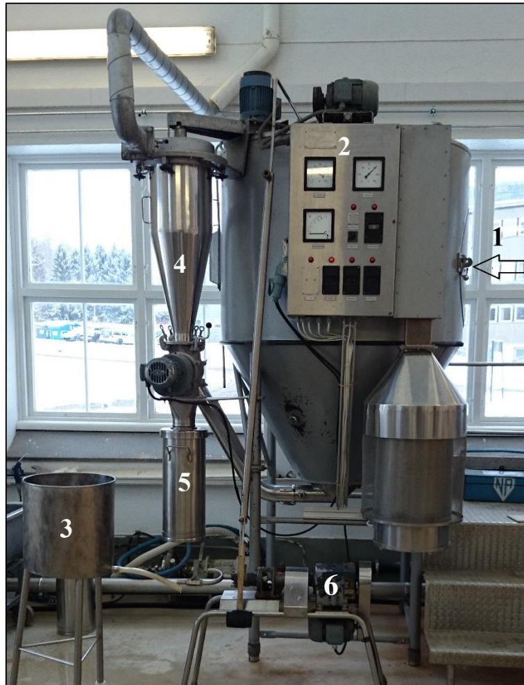
Figur 16. Bilde av tørkekammeret. Tegnforklaringer: 1. Luke inn til tørkekammer, 2. Styrepanel, 3. Balansekasse, 4. Syklon, 5. Oppsamler til pulver, 6. Matepumpe (Foto: Motrøen 2015).
