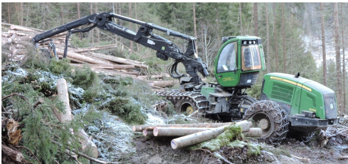
Bilde 4 John Deere 1270 opparbeider forhåndsfelt virke i Melhus. Foto: Sverre Husby
