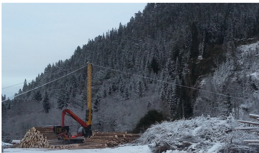
Bilde 1 T. Frivik taubanedrift avvirker svært bratt terreng med en Mouty 4000 kran, i Meldal, Sør-Trøndelag. Foto: Sverre Husby
