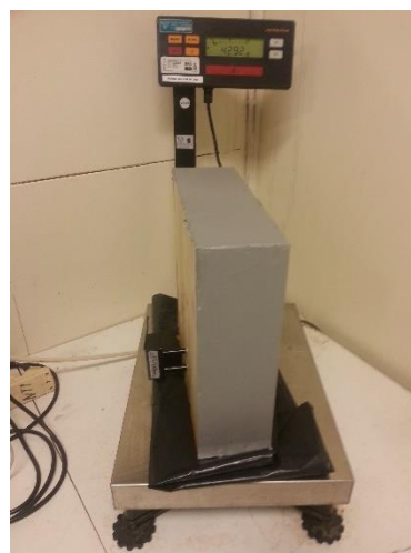
Figur 33 Vektmåling av en prøve på veicellen
