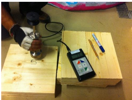
Figur 34 Trefuktighetsmåleren viser fuktprosenten i materialet
