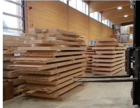
Figur 27 Ferdig sammensatt massivtre i hallen
