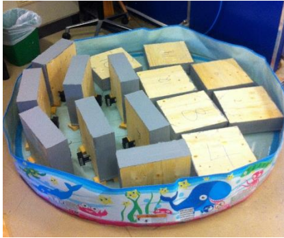
Figur 39 Oppfukting av vegger og gulv
