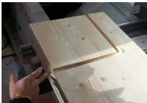
Figur 30 Dimensjonene ble kontrollert underveis etter at halve prøven var utskåret
