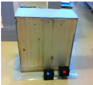
Figur 49 Plassering av veggsensorer
