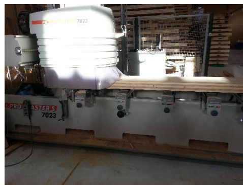
Figur 29 CNC- maskinen skjærer ut et av prøvestykkene
