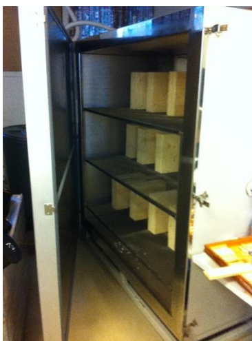
Figur 32 Prøvene satt i tørkeskapet
