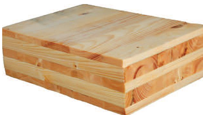
Figur 9 Viser eksempel på et sammenføyd krysslimt massivtreelement (Aarstad et al. 2008)
