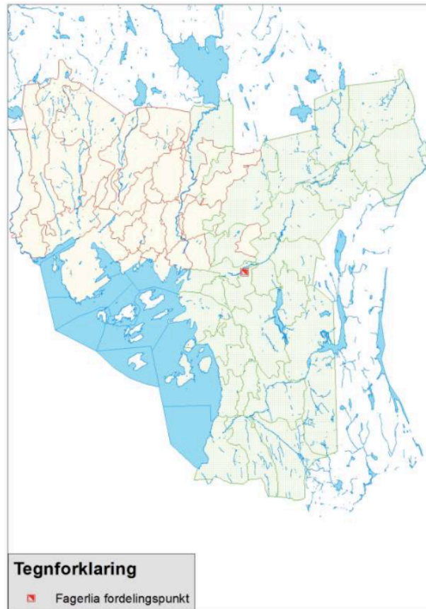
Figur 4: Oversikt over avløpssonene i Oslo. Avløp fra grønne soner renses normalt ved BRA. Avløp fra røde soner renses normalt ved VEAS (VAV 2014a).
