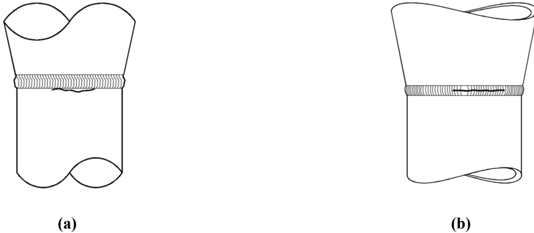
Figur 18: En sprekk kan initieres fra utsiden på sveisens tå (a), og fra sveisens rot (b) [37] .
