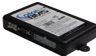
Figur 4.2: Orion Jr. BMS, bilde hentet fra produksiden til Orion BMS [15]
