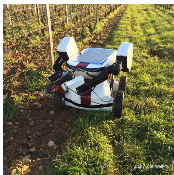
(a) Wall-ye. En fransk robot for vindruedyrking[42].
