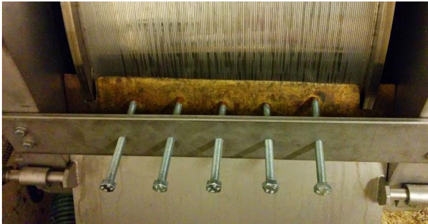
Figur 7.3 RDF300. Påmontert plate med fem justerbare skruer, for å kompensere for sprekk mellom skrape og trommel. Skruene legger press på skrapen.
