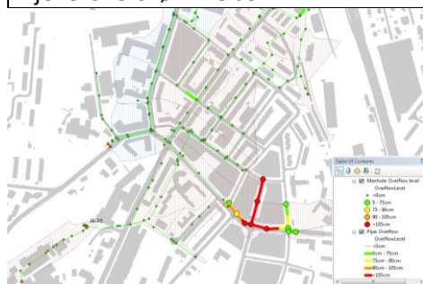
Figure 29 Simulering av det største nedbøret i 2010 med et klimapåslag på 50% etter frakobling av takvann i 5 catchments
