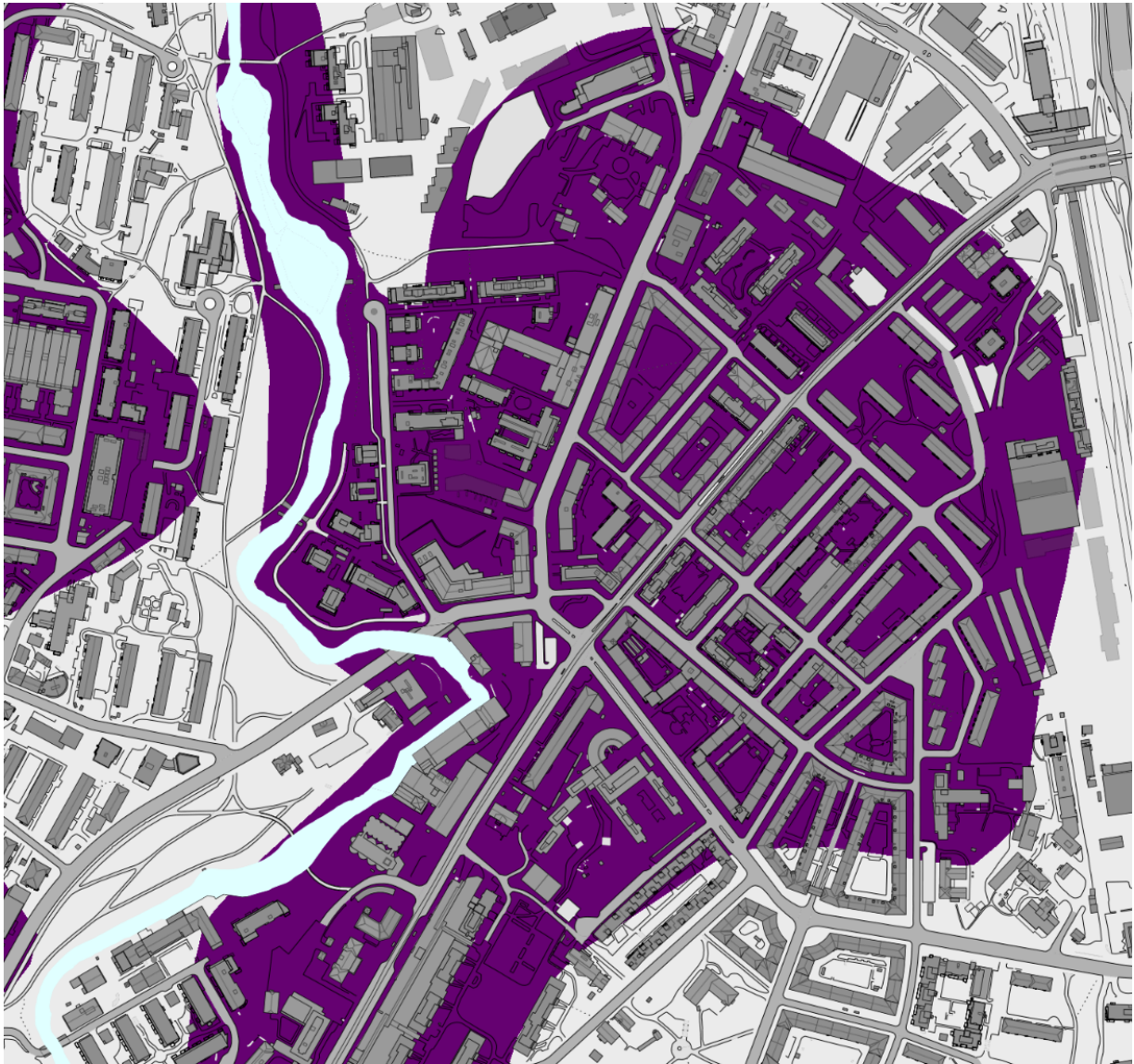
Figure 7 Kart over infiltrasjonsevnen på Sandaker, Oslo. Feltet består av elveavsetninger og tykk marin havavsetning. Dette er avsetninger som er godt egnet til infiltrasjon (NGU 2015).
