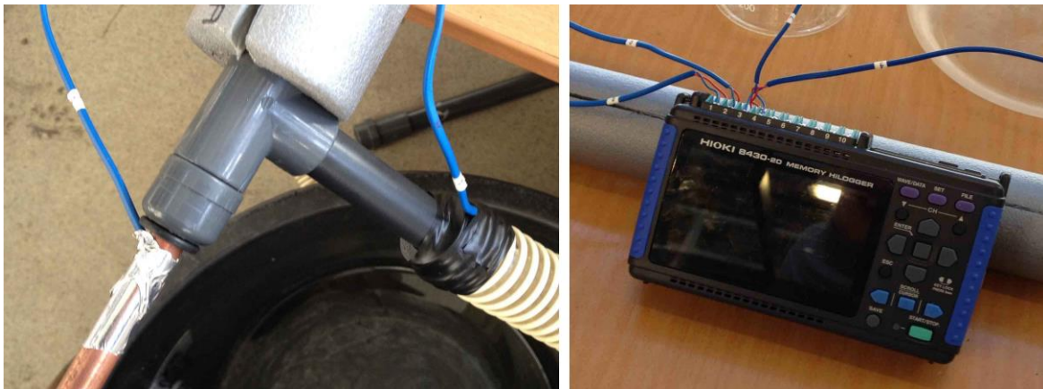
Figur 20 - Bildet til venstre viser hvordan de nye temperatursensorene er montert. På kobberøret er det benyttet aluminiums teip for god isolasjon rundt måle området. Inn mot PVC-røret er sensoren stukket gjennom slangen og tettet rundt med teip. Temperaturloggeren er vist til høyre.
