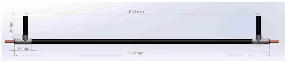
Figur 18 - Illustrasjon av varmeveksleren med påsatte dimensjoner.
