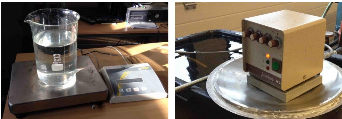
Figur 24 - Til venstre et bilde av vekten som ble brukt. Til høyre er apparatet som stabiliserte temperaturen og skapte sirkulasjon i vannmagasinet.
