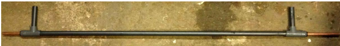
Figur 14 - Varmeveksleren ferdig montert.
