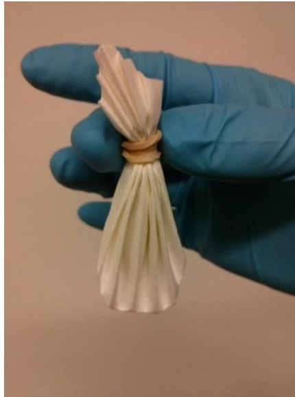
Figur 3.1: Figuren viser hvordan filterpapiret og strikken holder på fibret.
