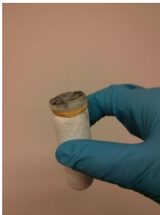
Figur 3.2: Figuren viser en av hylsene som ble brukt. Det aktive kullet ble holdt på plass i hylsen med parafilm festet med gummistrikk som dekket åpningen.
