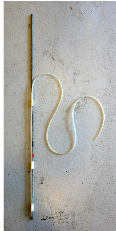
Figur 2.5: Stang og slange som ble benyttet til prøvetaking. Det røde merket viser hvor høyt stangen skulle løftes for å ta prøver av øverste prøvepunkt.
