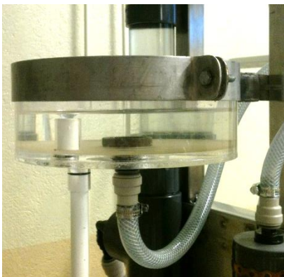
Figur 37: Nivå-kontroll-volum i utløpet av filteret. Foto: Anne Willumsen.
