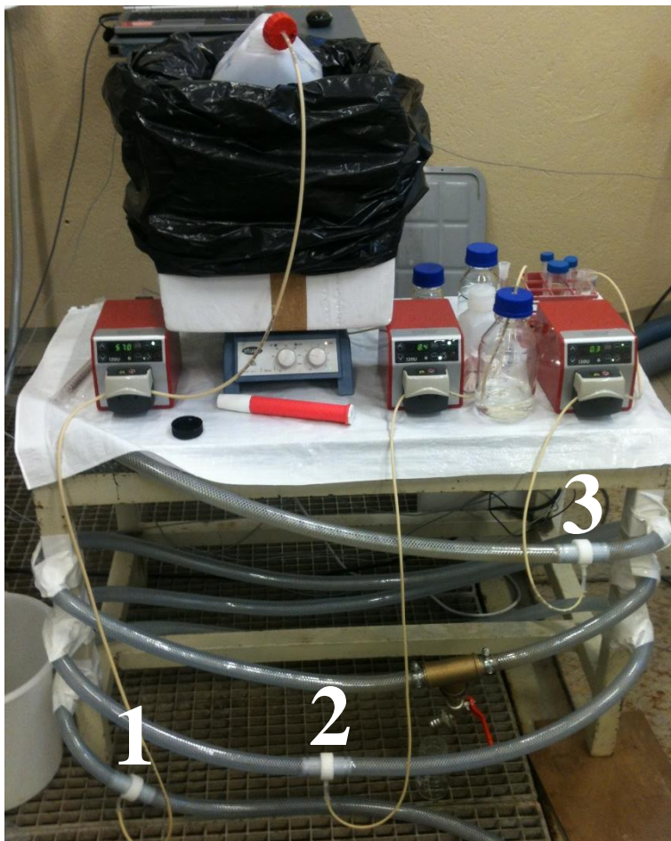
Figur 18: Fra venstre til høyre på bordet: pumpen som doserte mikroorganismer, beholder med mikroorganismer plassert oppå en magnetomrører, pumpe for dosering av syre og helt til høyre på bordet er pumpen som doserte koagulant. 1: mikroorganismer, 2: Syre og 3: koagulant. Foto: Anne Willumsen.
