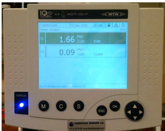
Figur 14: Displayet for turbiditetsmålingene, under forsøk. Foto: Anne Willumsen.
