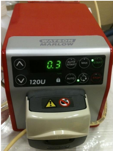
Figur 17: Pumpe for dosering av mikroorganismer og kjemikalier. Foto: Anne Willumsen.
