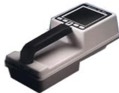
Figur 20: HunterLab skaper et avtrykk (dupliserer) som kan relateres til hvordan vi mennesker oppfatter fargenyansene i et produkt. Nedlastet: 19.2.2015
