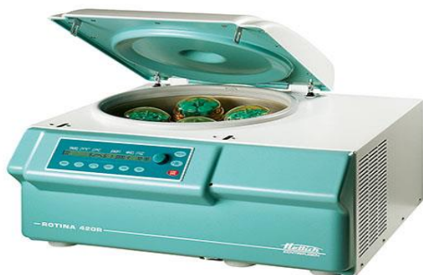
Figur 23: Hettich Rotina 420 ble benyttet for å analysere vannbinding. Metoden som er benyttet baserer seg på at maskinen sentrifugerer oppveid muskelmasse i metallsjaktler i 15 minutter med en hastighet på 15000 runder pr. minutt. Etter programmets slutt ble muskelen veid på nytt. (Hentet fra: www.hettichlab.com ) Nedlastet: 12.2.2015
