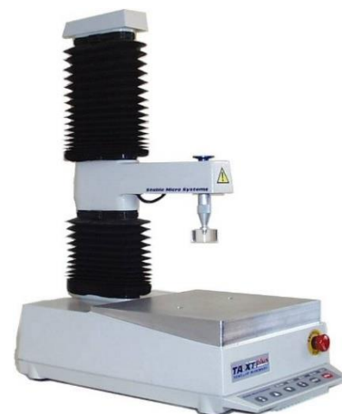
Figur 26: Tekstur Analyser TA-XT2 maskinen ble tilkoblet PC med programvare for avlesning av areal skapt av maskinens presskraft til 60% av laksemuskulens tykkelse. Skjærkraften har stor betydning for menneskets oppfatning strukturen til næringsmiddelene vi spiser (Hentet fra: www.texturetechnologies.com ). Nedlastet 1.2.2015
