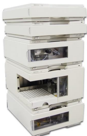
Figur 22: HPLC maskin benyttes for å separere komponentene i en viskøs væske for så å identifisere hver komponent. I denne oppgaven ble fett analysert for tilstedeværelse av karotenoider (astaxanthin) og andre flyktige komponenter (Hentet fra www.antech.ie) Nedlastet: 12.2.2015
