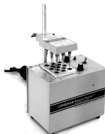
Figur 27: Pierce Reacti-Vap avdamper med varmeblokk og oppsett for gasstilførsel. I oppgaven ble avdamperen brukt til å dampe bort kloroformfasen i fettprøvene for å beregne totalt fett. Prøvene ble videre brukt til analysering på HPLC (Hentet fra: www.hitechtrader.com ). Nedlastet 1.2.2015
