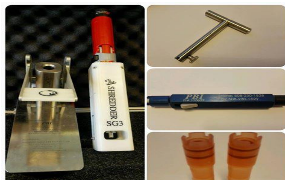
Figur 28: Systemet baserer seg på homogenisering av vev via spesialtilpassede tubes som har en ru overflate innvendig som risper opp vevet tilsatt Miro5 samtidig som den mekaniske shredderen lager turbulent strømning (vannvirvel) inne i tubsen. Presse på vevet kan justeres med tre forskjellige innstillinger på stativet. Hastigheten på maskinen kan ikke justeres. (Hentet fra: Eget foto)
