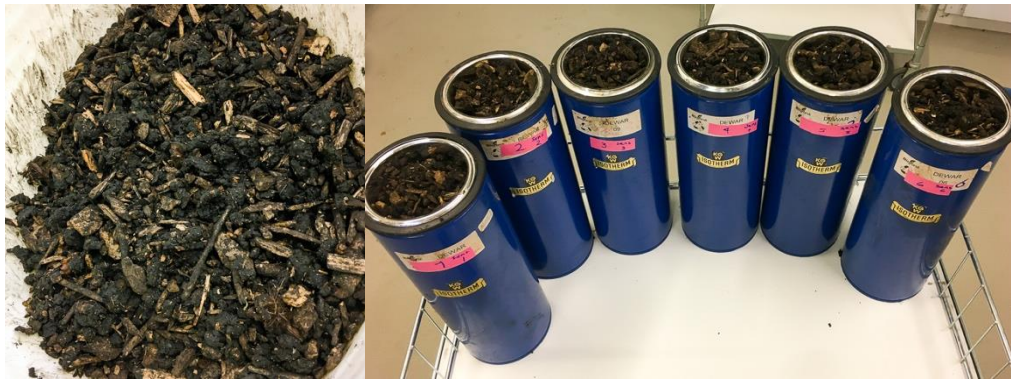
Figur D1. Det venstre for bildet viser komposteringsblandingen i bøtten med biorest: hoggflis til et volumetrisk forhold på 6,0 L / 6,2 L (v/v) i bøtten. Det høyre for bildet viser et egenvekt-forhold på 635 g / 247 g i hver Dewar-reaktor (Totalt 6 Dewar-reaktorer).
