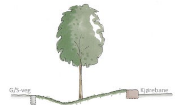
Figur 2.37 Prinsippsnitt av hvordan trær bør plasseres i forhold til grøftebunn. Illustrasjonen er hentet fra Statens vegvesen FoU "Lokal overvannshåndtering langs veg og gate". Kirstine Laukli (2017) Plassering av trær. Statens vegvesen.
