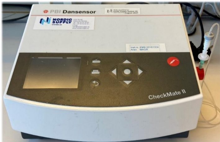
Figur 7. Illustrasjon av O 2 -og CO 2 -måleren CheckMate II (PBI Dansensor, Danmark). Foto: Privat
