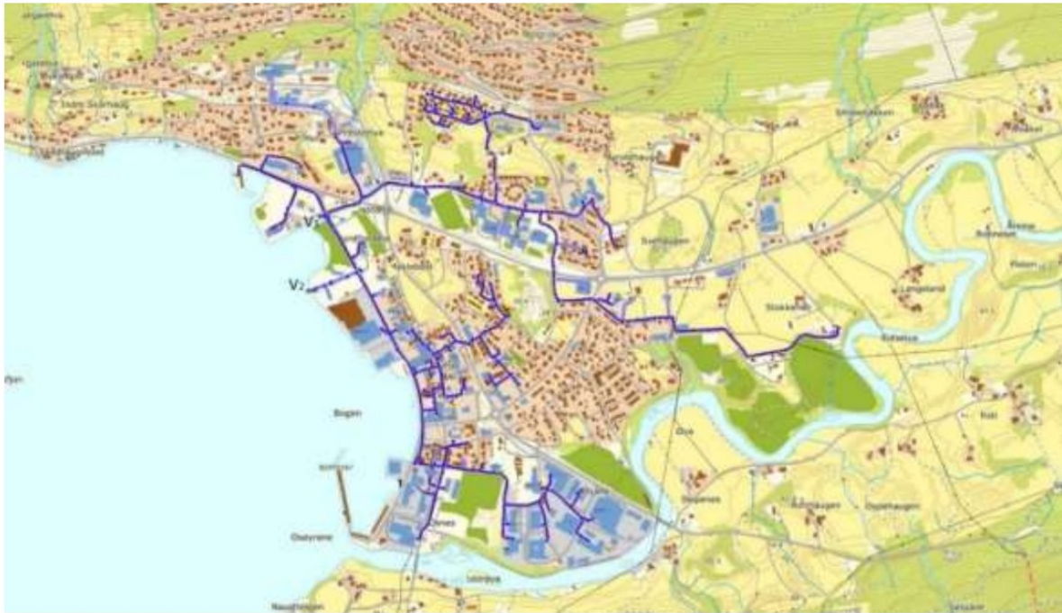
Figur 3. syner fjordvarmeanlegget på Nordfjordeid, dei blå linene viser røyrnettet som går ut til brukarane/einingane. V1 syner kvar det fyste vekslarhuset og V2 kvar det andre er lokalisert. ((FjordvarmeAS, u.å.)Redigert Bjørkedal)
