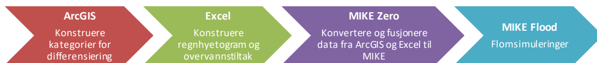
Figur 3-5: Generell beskrivelse av klargjøring av data for flomsimulering. Program markert øverst med tilhørende operasjon.
