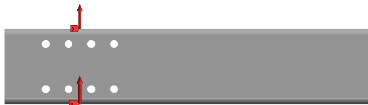
Figur 11.2. Snitt av motorarmen som viser posisjonen til kreftene i analysen.
