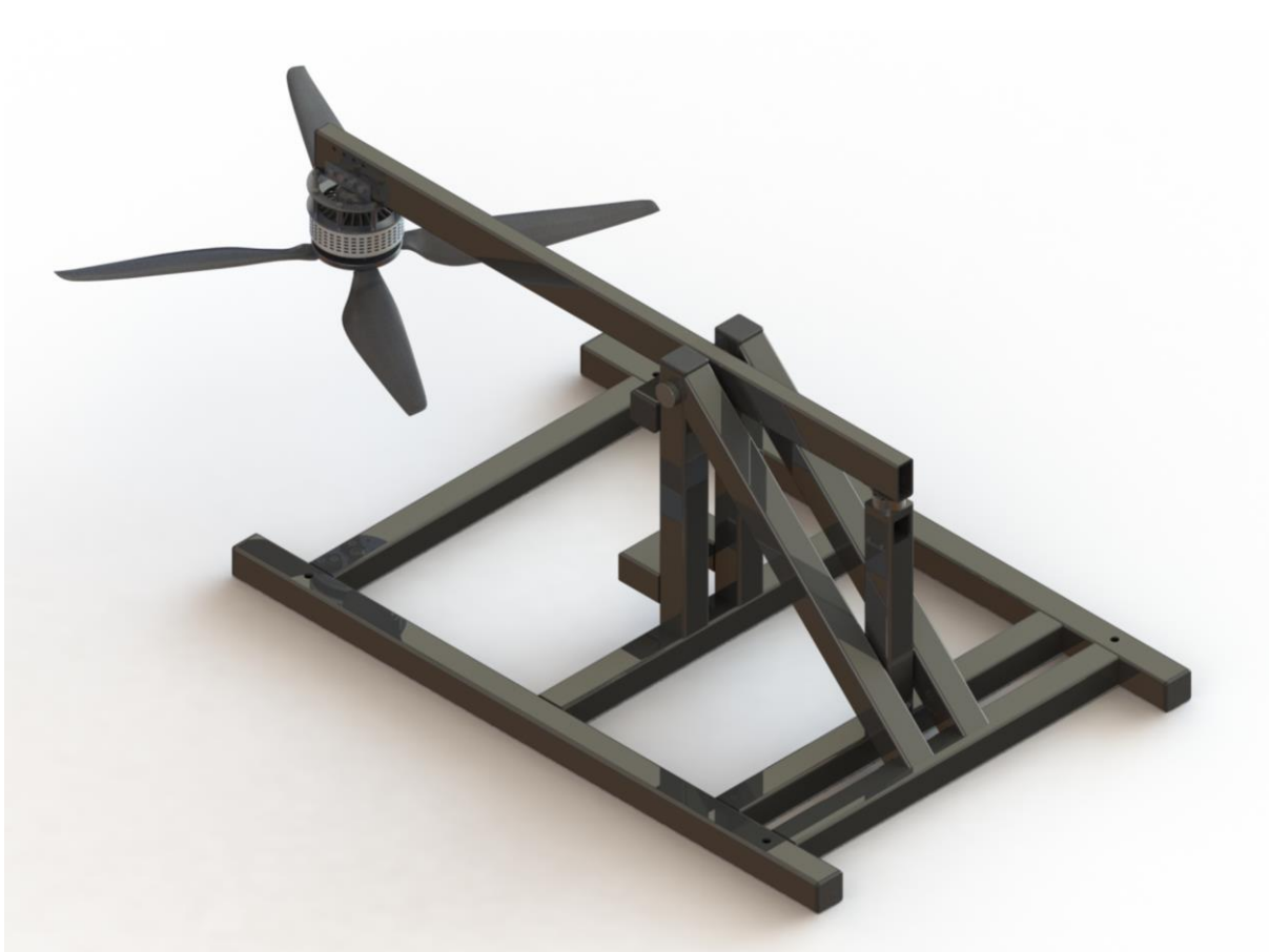
Figur 12.3. Testrigg med enkeltmotor i skyve-konfigurasjon og fire propellblader.
