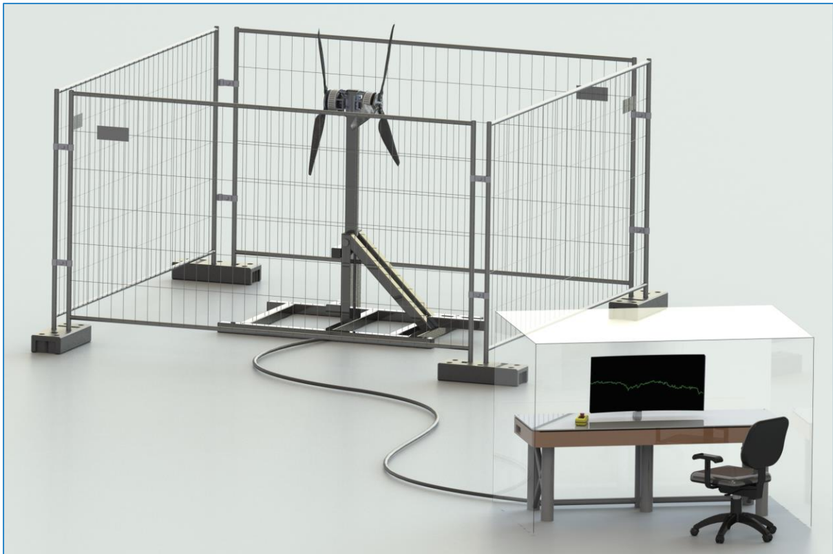
Figur 12.6. Fullstendig forsøksoppsett med testtrigg i vertikal testkonfigurasjon, dobbelmotor og tre propellblader per motor. Følgende deler er hentet fra nettet: sikkerhets-gjerde [47], styringskontroll med nødstop [48], benk og monitor [49], og stol [50]. Her demonstrert uten tetting av sikkerhetsgjerdet for å gi bedre innsyn til riggen.
