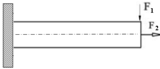
Figur 1.6: En bjelke som blir utsatt for 2 eller flere belastnings- og spenningstyper gir kombinerte spenninger. I dette tilfellet viser figuren en bjelke som blir utsatt for to krefter. F_1 gir bøyespenninger og F_2 gir strekkspenninger.
