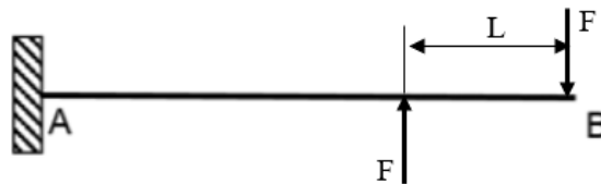
Figur 4.13: Kraften på enden av utkragerbjelken, og en motsatt kraft med distanse, L, fra kraften på enden av utkragerbjelken.
