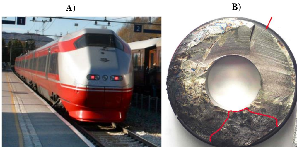
Figur 1.1: Akselbrudd hos Signaturtoget i år 2000, på Nelaug stasjon i Agder. A) Bilde av signaturtoget på stasjonen [1]. B) Bilde av bruddflaten i stålakslingen. Rød pil viser sprekkinitieringen, og innenfor linjemønsteret vises det at bruddet har vokst ved et antall belastningsvekslinger der sprekkveksten gradvis vokser seg innover akslingen [3].
