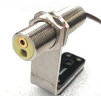
Figur 4.27: Føleren som ligger på passiv side mellom lagrene som registrerer turtall og brudd ved endring av turtall på akselen. Det antas å være en sensor med lasermåling [36].
