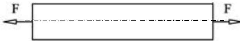
Figur 1.3: En bjelke som utsettes for strekkrefter som gir strekkspenninger [21].
