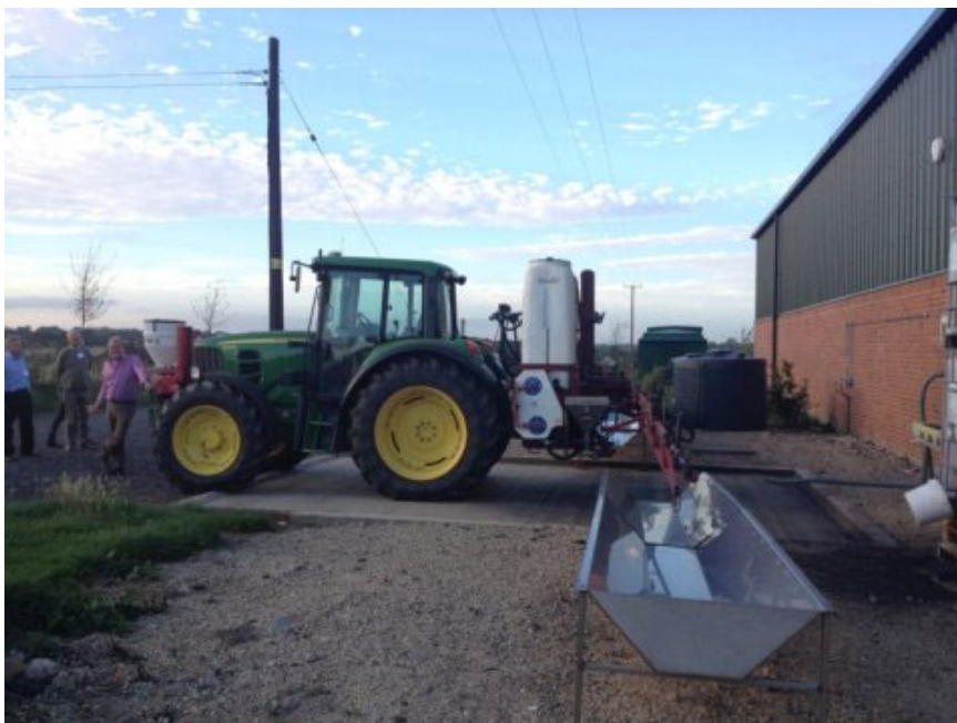
Figur 23. Renner for å samle opp vaskevann når bommen er slått ut på sprøyta (Foto: T. Meadows)
