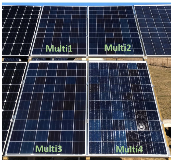
Figur 3.1: Oversiktsbilde over monteringen av de fire mc-Si solcellemodulene produsert av Swemodul som benyttes i oppgaven. Modulene er navngitt, Multi1, Multi2, Multi3 og Multi4 etter plassering. Oppsettet viser Multi4 etter den er påført synlige skader.
