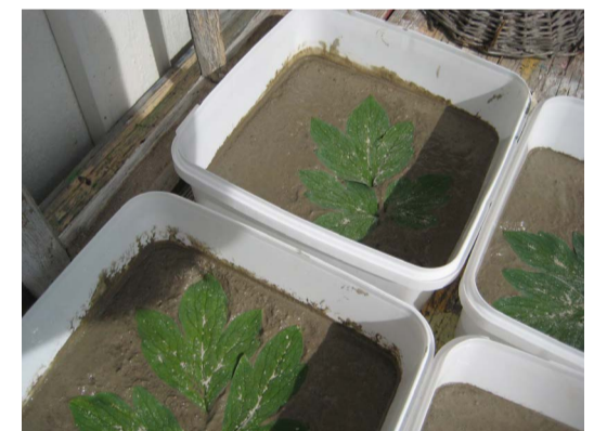
Figur 5.3: Eksempel på tråkkheller som støpes i gamle isbokser.
