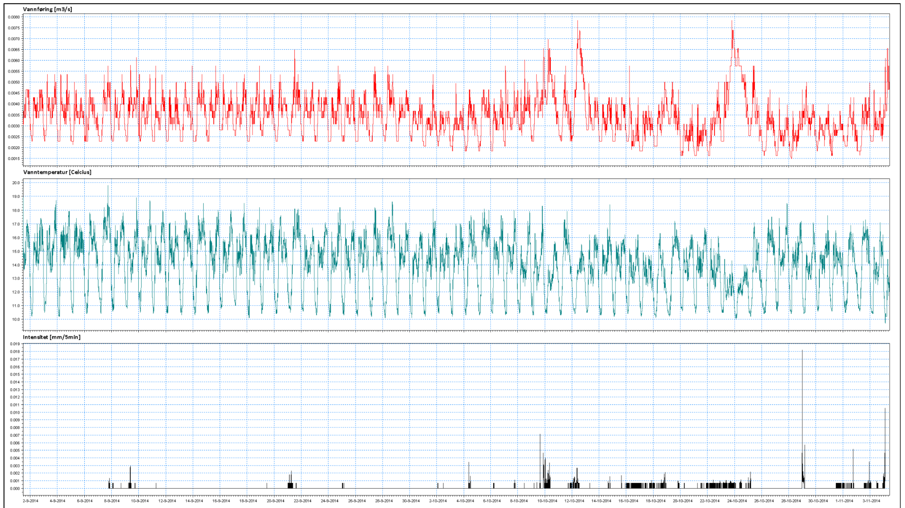
Figur 47: Vannførings- og temperaturmålinger for spillvannet i kum 274119 plottet sammen med nedbørsmengde
