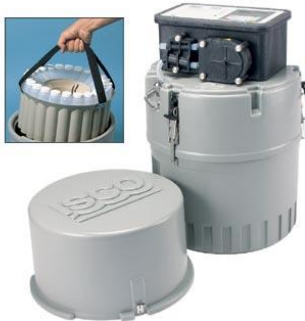
Figur 19: Isco prøvetaker med karusell med 24 a 500ml flasker (Teledyne Isco 2014).
