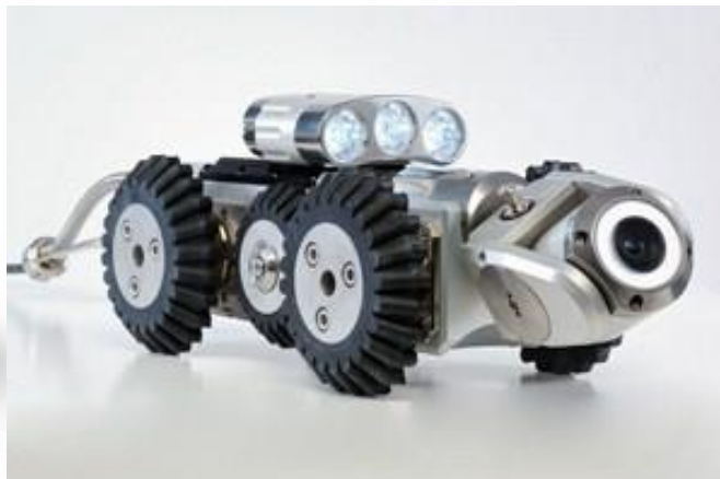
Figur 22: Kamerarobot benyttet til TV-inspeksjon av rørledninger (Robosnap 2014).
