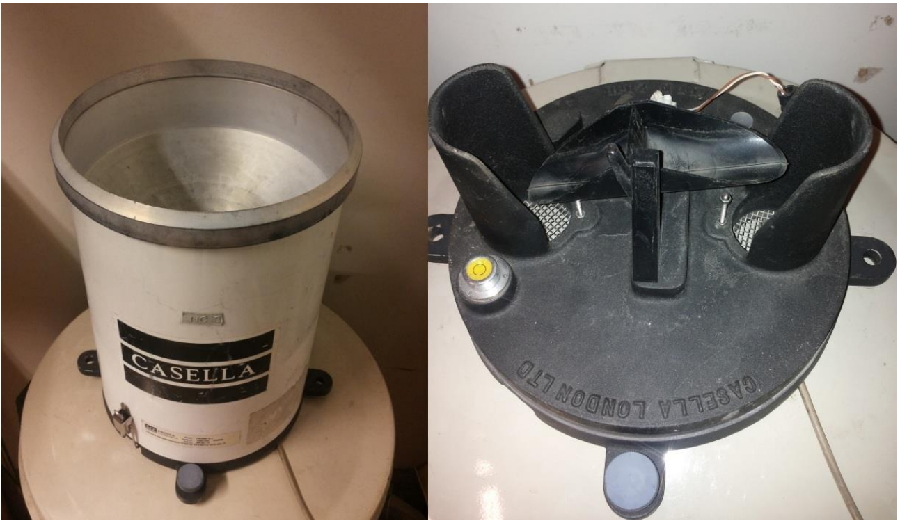
Figur 14: Casella nedbørsmåler og vippekarfunksjon (Målegruppe avløp 2014).
