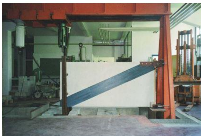
Figur 24 Forsterkning ved hjelp av FRP diagonalt på en bærende vegg. Bilde hentet fra Premrov og Dobrila (2008)
