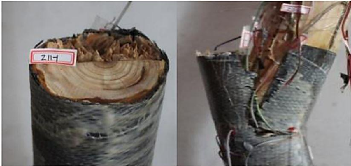
Figur 35 Brudd i søyle forsterket med CFRP. Bilde til venstre er forsterket med ett lag i fiberretning, bilde til høyre har dobbelt lag i fiberretning. Bilder hentet fra Li et al. (2018)
