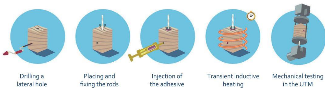
Figur 32 Fremgangsmåte for forsøk gjort av (Ratsch, N. et al., 2019) med induktiv herdeprosess. Først bore hull, så sette inn stang, fylle på lim og deretter herde limet ved bruk av induksjonssløyfer rundt elementet.
