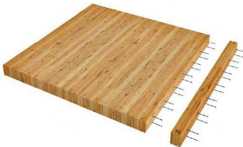
Figur 11 Kantstilt element satt sammen med stålstag/skruer (Finch, 2016)
