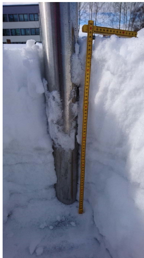
Figur 15 Snøtaksering som viser snødyb og islag under snødekket 20.03.017
