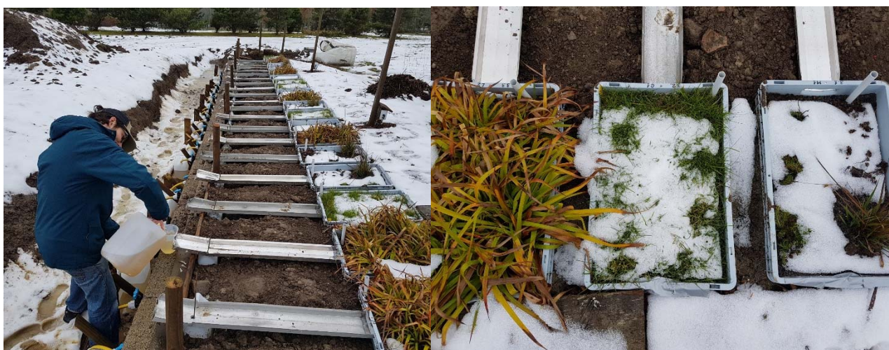
Figur 20 Plantekasseforsøk, NMBU, 15.11.2019 til venstre viser innsamling av drenert vann og overflateavrenning, til høyre plantedekket delvis dekket av snø, fra venstre mot høyre: Luzula sylvatica , gress, planteblanding (Foto: Marina Bakhtina)
